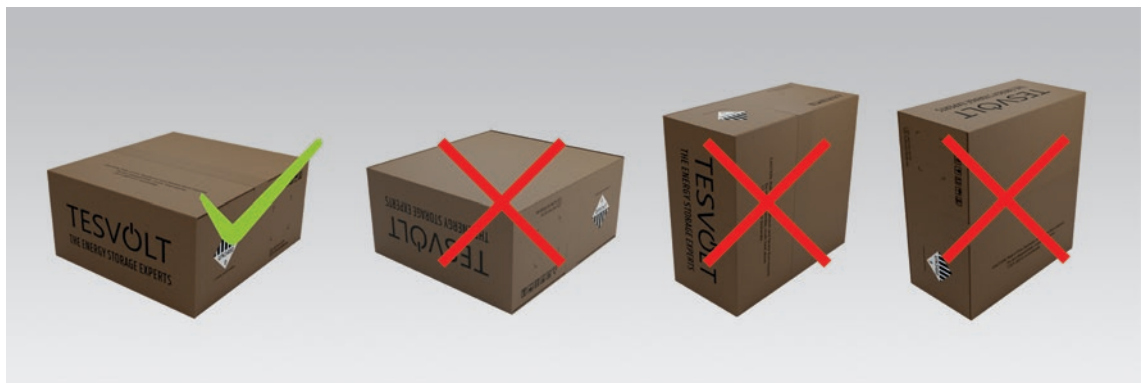
Abbildung 3.1 Zulässige und unzulässige Lagerungspositionen eines verpackten Batteriemoduls
